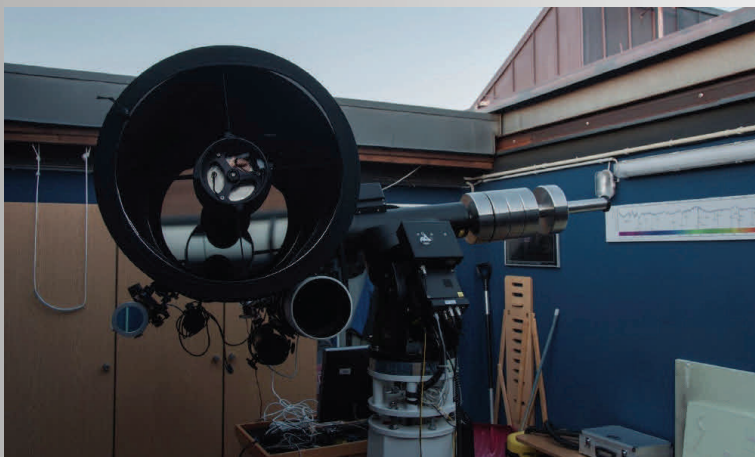
Abb. 4: Auf der Sternwarte am CFG ist das CDK-20 fest auf der parallaktischen Montierung GM 4000 HPS II montiert.
